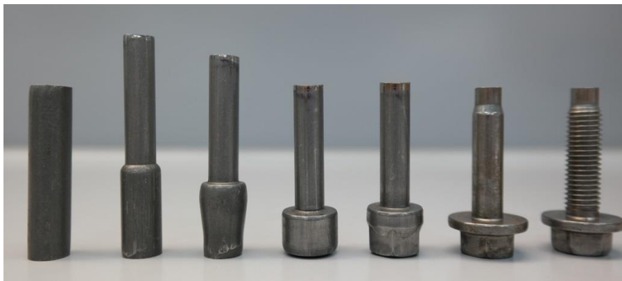
Abb. 2: Herstellungsschritte der Schraube vom Drahtabschnitt bis zum fertigen Produkt
