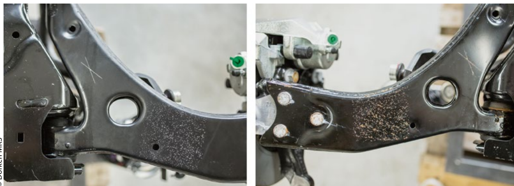
Dreieckslenker mit Zinklamellen-Beschichtung (links) erfüllen auch nach erhöhter Steinschlagbelastung alle gestellten Anforderungen im Salzsprüh-test; im Vergleich ein Dreieckslenker ohne Zinklamellen-System (rechts).
