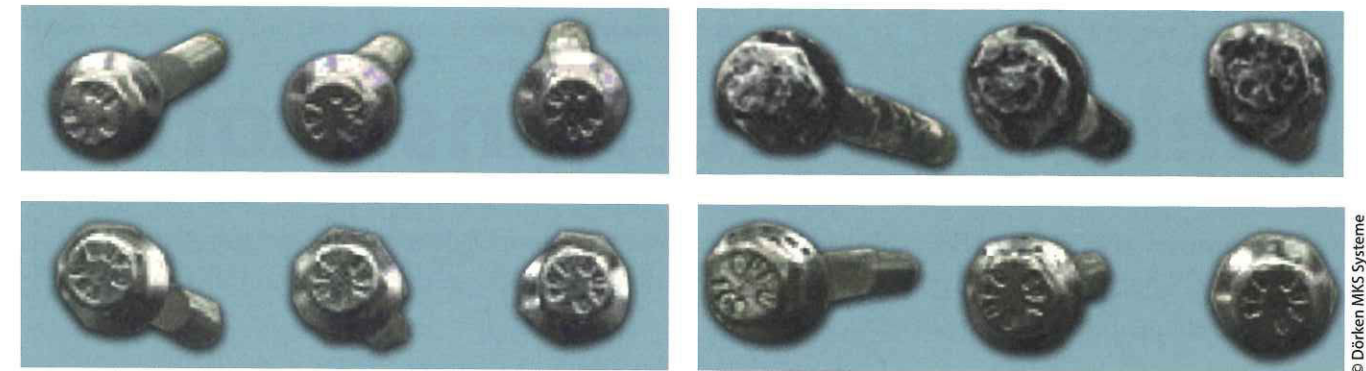
Schrauben vor (links) und nach (rechts) 240 Stunden im neutralen Salzsprühnebeltest: Im Vergleich zur einstufigen Passivierung (oben) zeigt die zweistufige (unten) erheblich bessere Ergebnisse.
